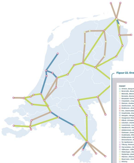
Figuur 20. Overzicht van verbindingen (blauw gekleurd) die naar 4kA opgewaarderd worden.
