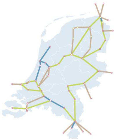
Opwaarderen EHS (220/380 kV) naar 4kA
